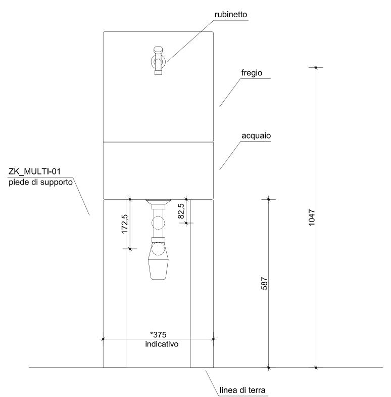
\* N.B. verificare l'interasse delle staffe di supporto, montandole sotto la vasca dell'acquaio, prima di forare il muro. Il prodotto essendo artigianale può subire una variazione delle misure del 2%.
