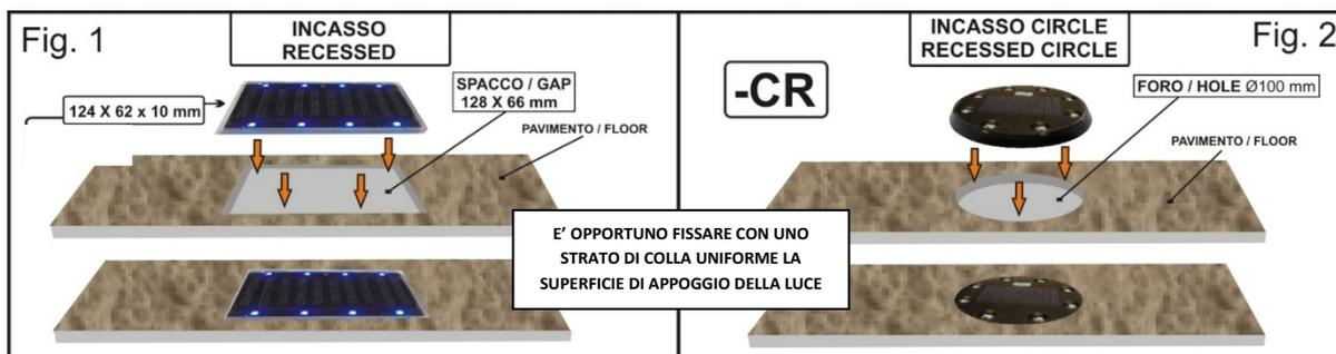
Il modulo da incasso può essere fissato con orientamento orizzontale o verticale con una tolleranza massima  $\pm 1$ mm rispetto al livello della mattonella/pavimento adiacente.
