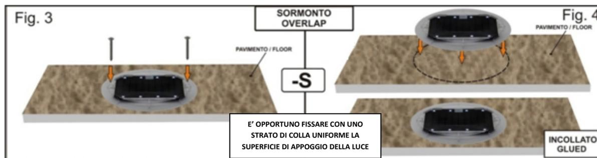
Il modulo da sormonto può essere fissato tramite i 2 fori preposti o incollato a pavimento o parete.
